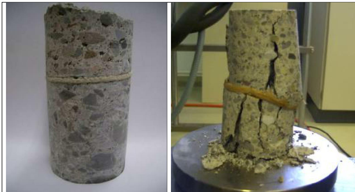
Obr. 6 Stříkaná hydroizolační membrána a její chování při zatížení
