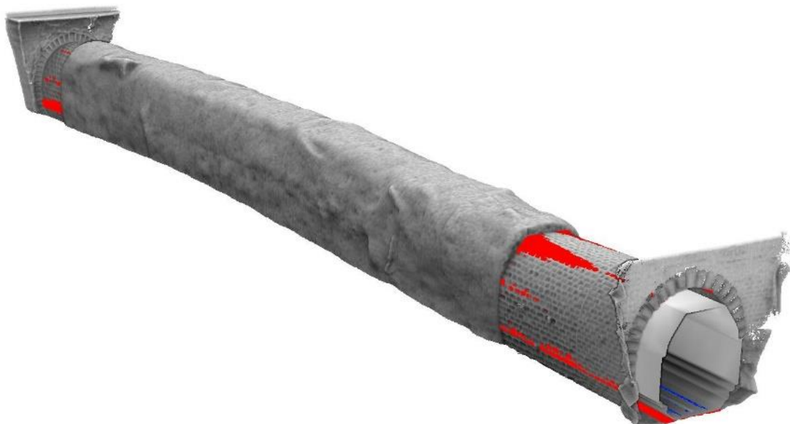
Obr. 2 Průkaz prostorové průchodnosti na 3D modelu (Žďárský tunel)
